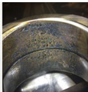
Corrosion au soufre sur bague de pied et coussinets de bielle = risque de rupture sévère à court terme
