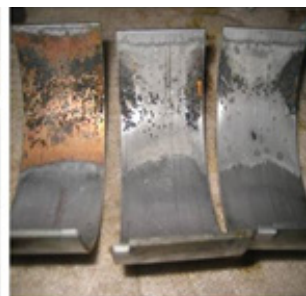
Corrosion au soufre sur bague de pied et coussinets de bielle = risque de rupture sévère à court terme
