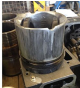
Grippage piston : température de combustion trop élevée, acidification de l'huile
