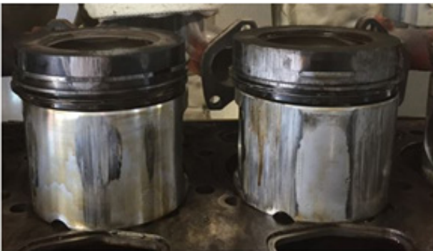
Grippage piston : température de combustion trop élevée, acidification de l'huile
