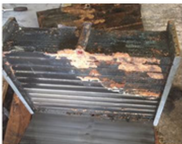
Intercooler corrodé par des dépôts soufrés = perte de puissance
